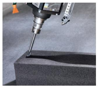
A unidade de 5 eixos, com motor em retirada direta, permite a máxima flexibilidade nos processamentos inclinados e interpolados, sem perigo de esforço excessivo. A BIESSE OFERECE SOLUÇÕES TECNOLÓGICAS PARA PROCESSAR OS MATERIAIS MAIS COMUNS E PROCURADOS NO MERCADO, COMO: PE, PP, PVC, PMMA, MAS TAMBÉM COMPÓSITOS, TECNOPOLÍMEROS, BORRACHAS, EXTRUDADOS E EXPANDIDOS.
