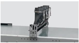
Sistema com 2 a 4 coifas de aspiração localizado sobre a esteira de descarga.
