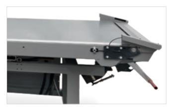
Coletor de aspiração localizado na parte inferior da esteira.
