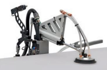
O novo sistema de alinhamento gerencia a separação e a carga alinhada de materiais respiráveis e/ou finos de até 3 mm de espessura ou altamente aderentes.
