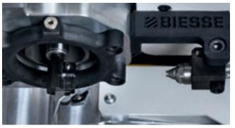
Sistema de lubrificação de ferramenta para cortador permite o melhor deslizamento da lâmina dentro de materiais particularmente densos ou elásticos, graças a um sistema de nebulização de ar-óleo que garante a lubrificação da ferramenta durante o corte.
