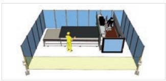
É possível configurar a máquina com a função pendular para poder usinar painéis em origens opostas de maneira alternada e realizar, dessa forma, as operações de carga e descarga em tempo "mascarado".
