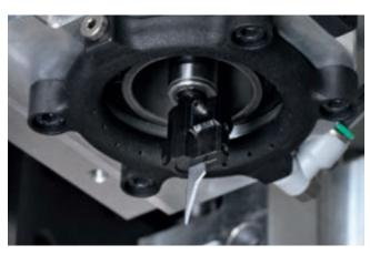
Dispositivo soprador para a unidade de corte permite reduzir o superaquecimento da lâmina e o consequente dano a alguns tipos de materiais, garantindo ao mesmo tempo a limpeza da área de corte removendo o pó e outros resíduos de processamento.
