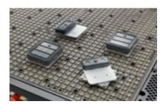
Módulos FT com adaptador de alumínio. A bancada FT PLUS facilita o posicionamento dos módulos, garantindo a máxima estabilidade.
